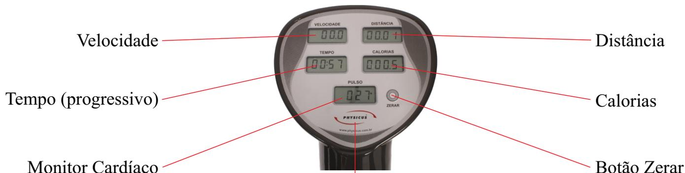
Obs.: O painel funciona com 2 pilhas normais, localizadas na parte interna (traseira) do painel. Para trocá-las, remova a tampa traseira do painel (3 parafusos *phillips*).
